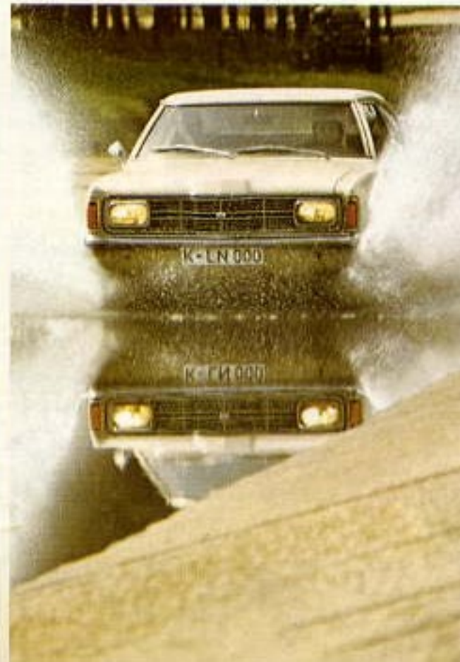
▲ In Lommel (Belgien) besitzt Ford eines der größten Prüfgelände Europas ▼ Grundierung im Elektrotauchbad Salzwasserdurchfahrten überprüfen die Rostbeständigkeit ▼
