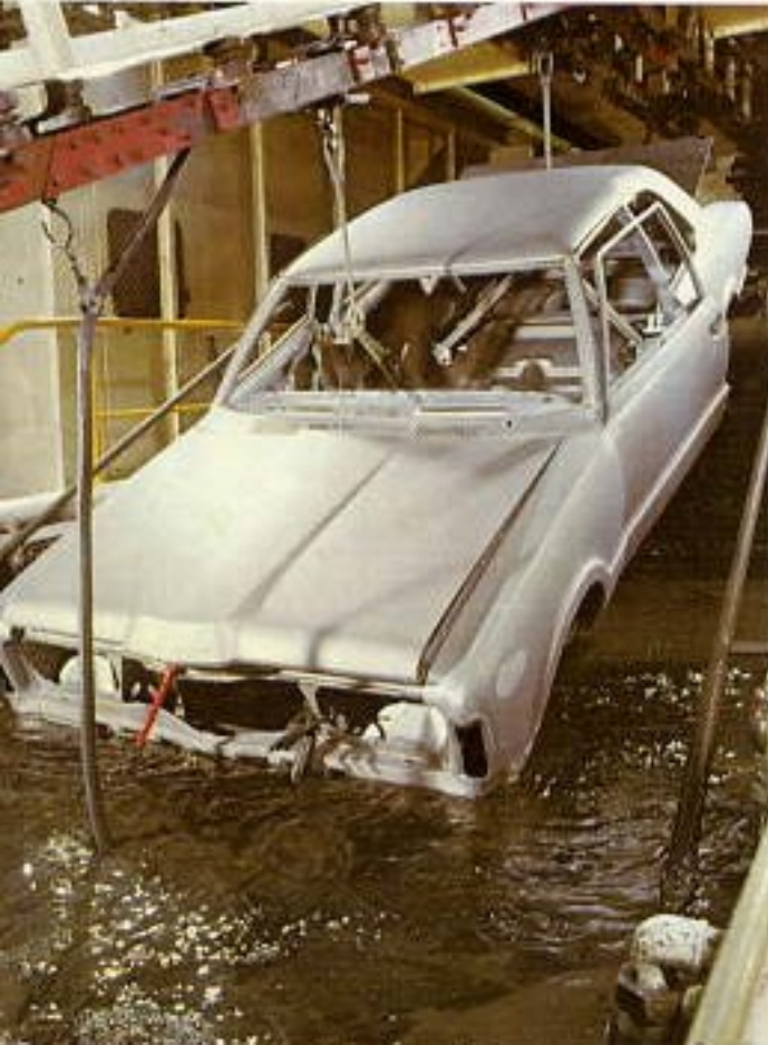
▲ In Lommel (Belgien) besitzt Ford eines der größten Prüfgelände Europas ▼ Grundierung im Elektrotauchbad Salzwasserdurchfahrten überprüfen die Rostbeständigkeit ▼
