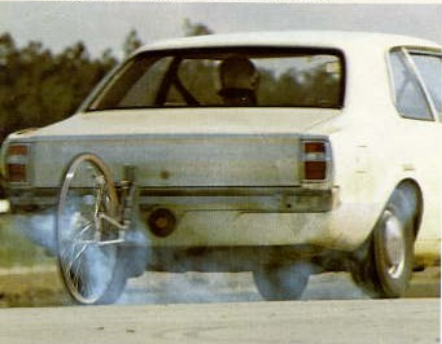
▲ Bremsentest auf dem Ford-Versuchsgelände
